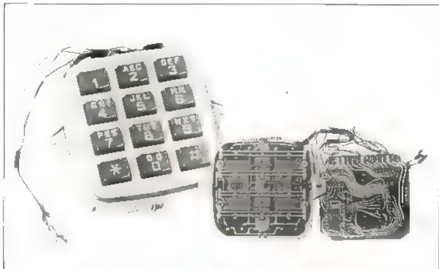
Photo 1. — Faces intérieure et extérieure d'un appareil téléphonique. Son système de fixation et ses dimensions lui permettent de se substituer à n'importe quel cadran classique.
